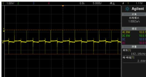
图 2.C1 处无陶瓷电容，纹波峰峰值 2.69V
