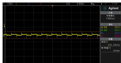
图 5.陶瓷电容靠并联在 CIN 两端，纹波峰峰值 0.92V
