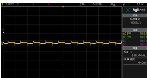
图 4.陶瓷电容位置在 C1 处，纹波峰峰值 0.64V
