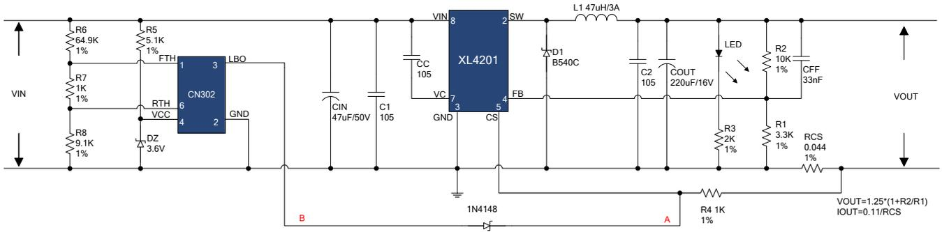
工作原理：CN302 电压检测芯片供电电压在 2~6V 之间，通过 DZ 稳压管供电，此处选择 3.6V 稳压管供电；当输入电压高于  $U_2$  时，B 点电压为 0.3V，小于 1N4148 的  $V_F$  值，芯片可以正常工作；当输入电压低于  $U_1$  值时，B 点产生高电平，通过 1N4148 将高电平加至 CS 引脚的 A 点处，从而实现芯片关机。
