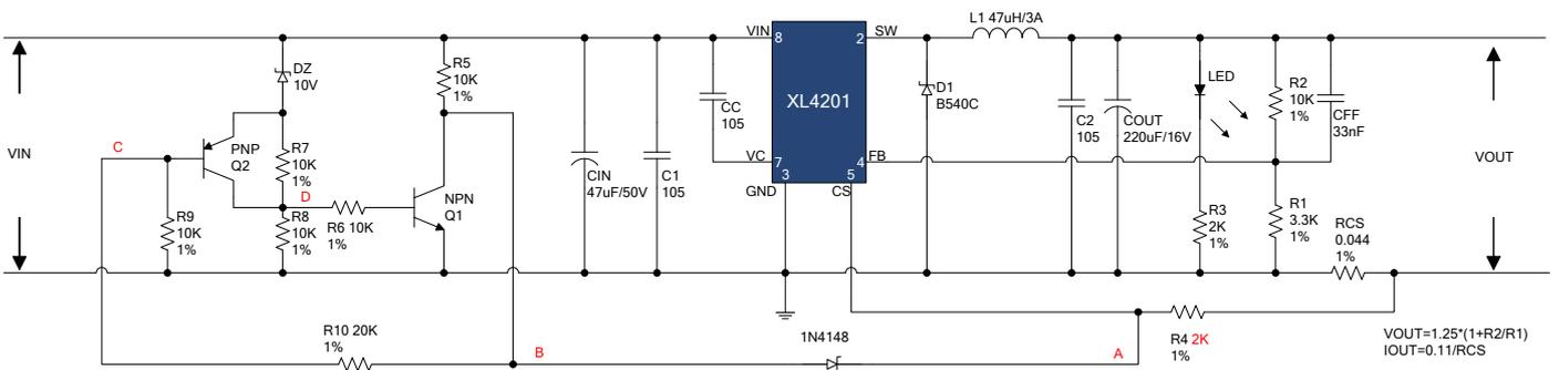
工作原理：初始状态，三极管 Q1 与 Q2 均处于关闭状态，当输入电压击穿稳压管 DZ，在 D 点产生 0.7V 左右电压后，Q1 导通，B 点电压近似为 0，低于 1N4148 的 VF 值，芯片可以正常工作；Q2 三极管随着 Q1 导通后导通，Q2 导通后短接 R7 电阻；当 VIN 电压低于 VDZ+0.7V，三极管 Q1 关闭，此时 VIN 通过 R5 电阻和 1N4148 将高电平加至 CS 引脚的 A 点处，芯片关闭无输出，由于此电路的开启与关闭电压不一致，从而实现带有滞回功能的欠压关机电路，避免输入电压降至临界点时，出现系统来回开机与关机现象；
