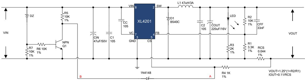
工作原理：当 VIN 电压高于 VDZ+0.7V 时，Q1 导通，B 点电压近似为 0，小于 1N4148 的 VF 值，芯片可以正常工作；当 VIN 电压低于 VDZ+0.7V 时，三极管 Q1 不导通，此时 VIN 通过 R5 电阻和 1N4148 将高电平加至 CS 引脚的 A 点处，从而实现欠压关机功能。
