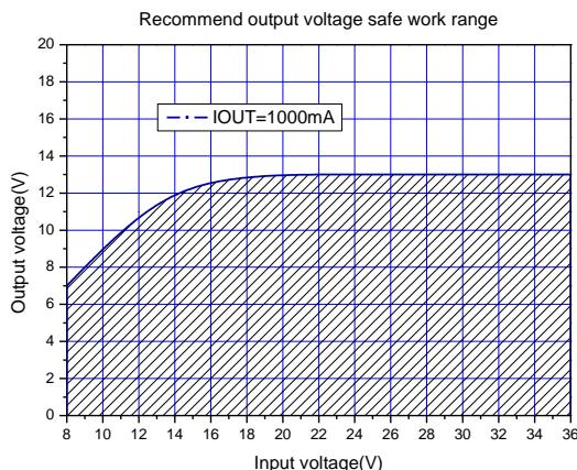
Figure14.Max output voltage(IOUT=1000mA)
