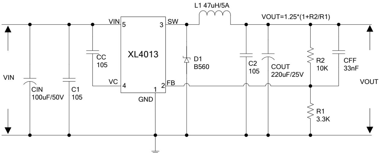
图 4. XL4013 系统参数测量电路(VIN=8V~36V, VOUT=5V/4A)
