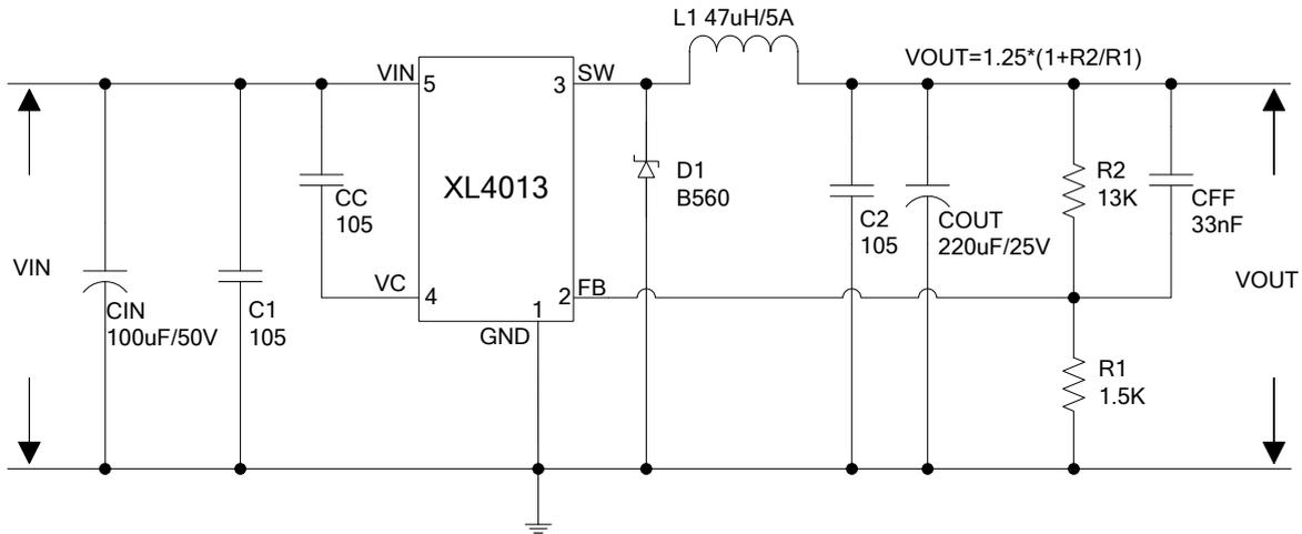
图 7.XL4013 系统参数测量电路 (VIN=15V~36V,VOUT=12V/3A)
