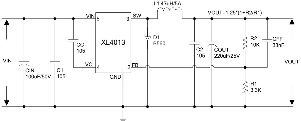
图 5.XL4013 系统参数测量电路 ( VIN=8V~36V,VOUT=5V/4A )
